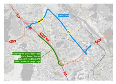
Dans le cadre de la rénovation des chaussées de la Francilienne (N104) extérieure au niveau d'Évry-Courcouronnes, ce revêtement innovant à fort taux de recyclage sera posé sur une section de 2 à 3 voies de circulation, d'environ 2,5 km de long, qui supporte un trafic cumulé de 100 000 véhicules par jour.
